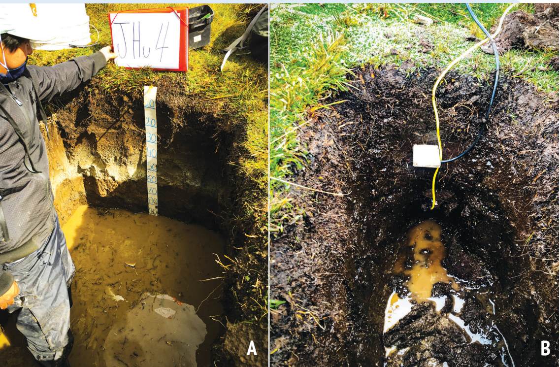
Figura 11. A. Perfil del suelo de una turbera, B. Sensores de humedad del suelo a diferentes profundidades de una turbera
